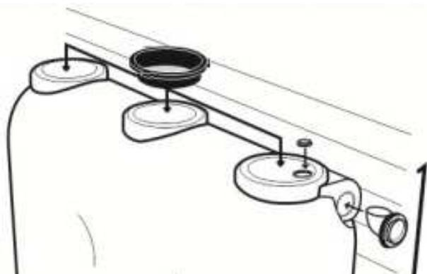
**Cortando o buraco de escoamento** no final do tanque usando uma serra copo, use como referência o anel interno para usar a saída de 3".
