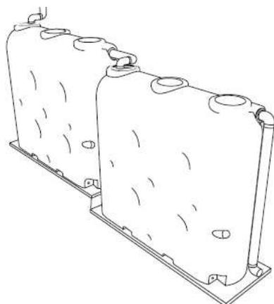
Coloque o bujão na parte superior dos tanques ligados, quando ocorrer a interligação de dois ou mais tanques é obrigatório a interligação da ventilação superior. A não interligação anulará a garantia.
