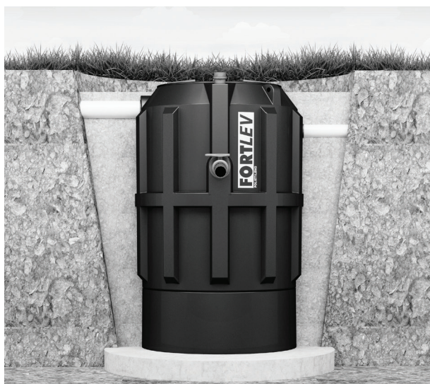
Figura 09 – Aterro completo com compactação.
