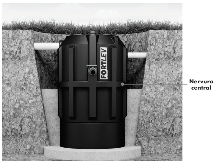
Figura 08 – Aterro com compactação até o início da nervura central.
